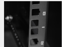
Perfiles de rack numerados
